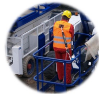
3. Auffangsystem mit mitlaufendem Auffanggerät einschließlich beweglicher Führung
